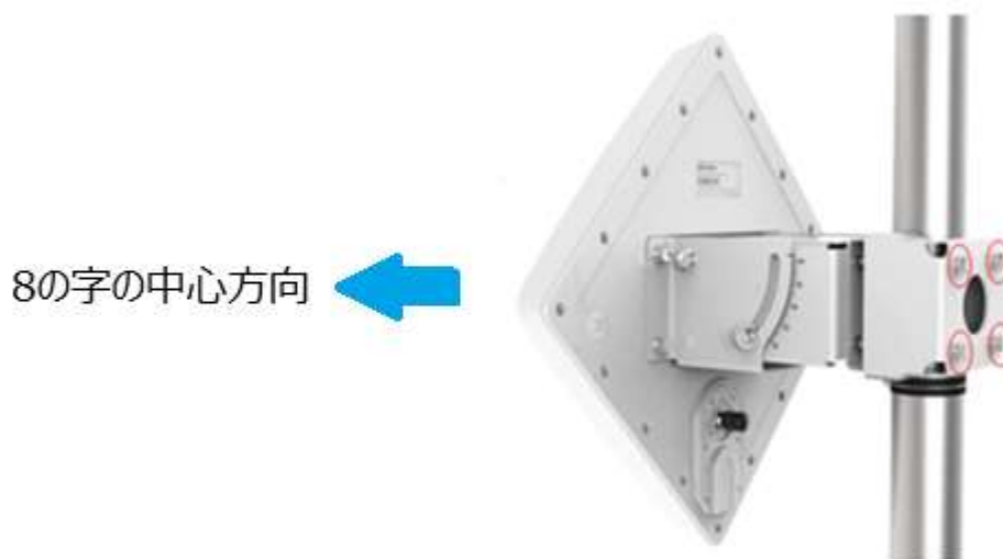
図 18 屋外設置アンテナの取付け
